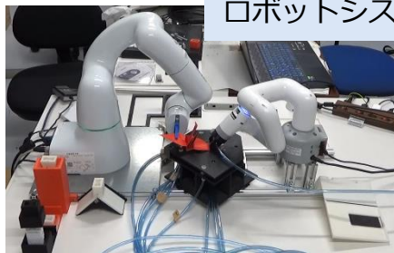
折鶴を自動で折る ロボットシステム
